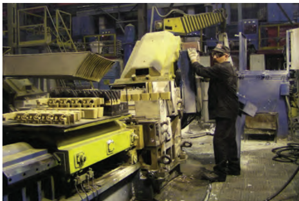
Рис. 2. Карусельно-кокильная машина мод. 4980 в литейном цехе ООО «Литейный завод «РосАЛит»(бывший литейный цех ОАО «ЗМЗ», Россия)
