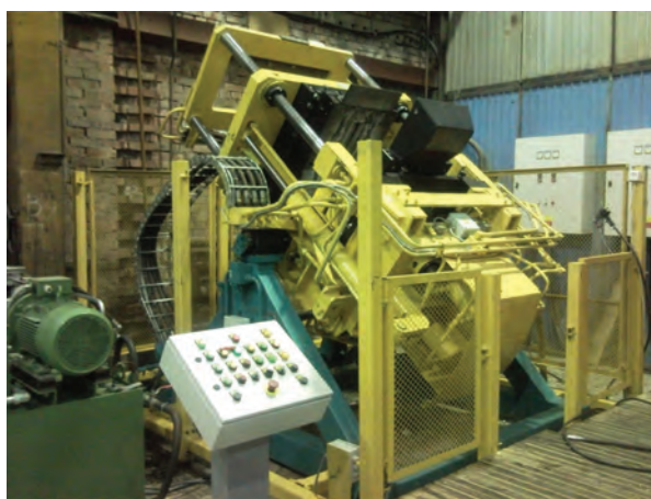
Рис. 4. Кокильная машина мод. 49102 (а) и отливка «Основание» (б)
