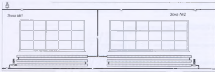
Рис. 4. Зонная двухтрубная система отопления производственного помещения с опрокинутой циркуляцией с зонными регулирующими клапанами
