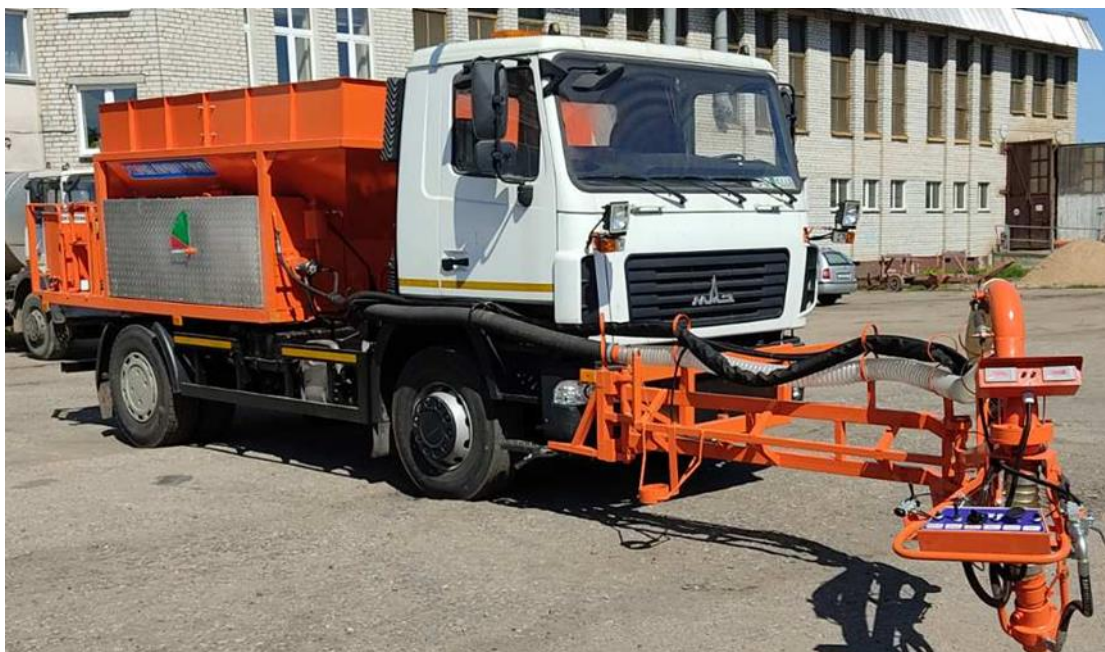
Рисунок 2 – Установка ямочного ремонта асфальтобетонных покрытий дорог ДС-273М-04 на базе автомобиля МАЗ 534013
