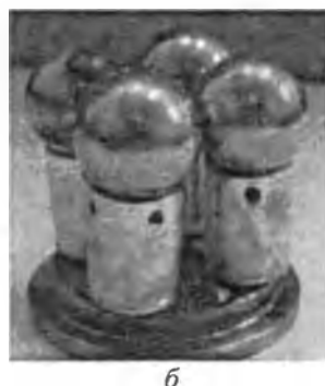
Рис. 4. Схема расположения соединений, получаемой на металлической поверхности образца имплантата (а) и фотография общего вида собранной конструкции (б): 1 – образец металлического имплантата; 2 – образцы имитатора костной ткани; 3 – стальные шарики, установленные в отверстия оправок
