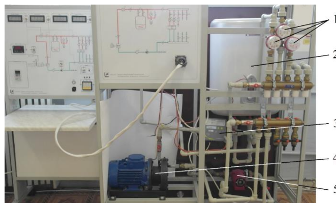
Рисунок 2 – Общий вид экспериментальной установки на базе вихревого теплогенератора 1 – расходомеры F2-F4 ; 2 – бак-накопитель (30 л); 3 – расходомер F1 ; 4 – вихревой теплогенератор ВТГ-2,2; 5 – насос
