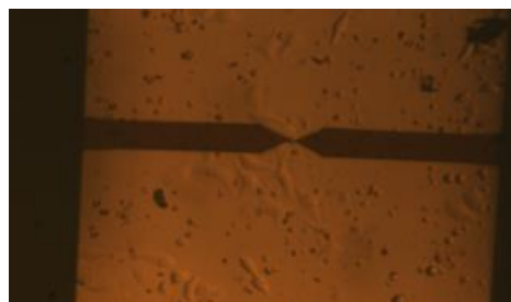
图 1 – 双探针原子力显微镜探针精密操纵 NK-92 细
