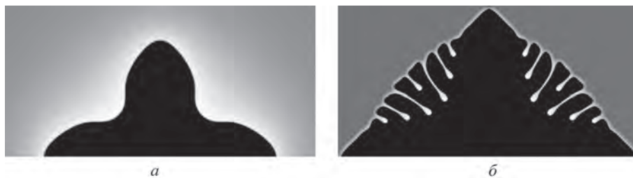
Рис. 4. Результаты моделирования: a – начальная стадия формирования дендрита без смывания примеси; б – ветвление кристалла при наличии смывания примеси
