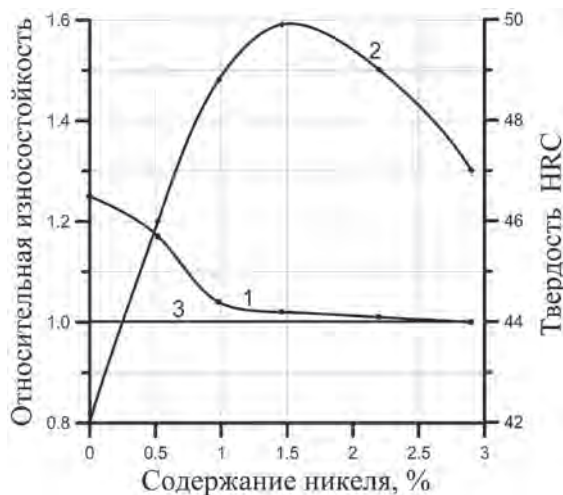
Рис. 2. Влияние никеля на твердость и износостойкость чугуна 290X19Г4: 1 – относительная износостойкость; 2 – твердость; 3 – эталон 280X28H2
