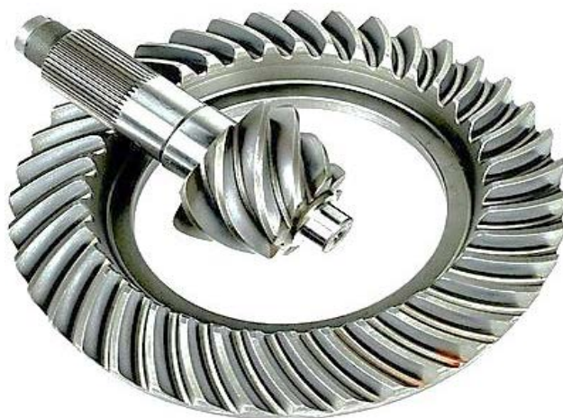
Рисунок 1 – Коническая зубчатая пара, полученная 3D-печатью
