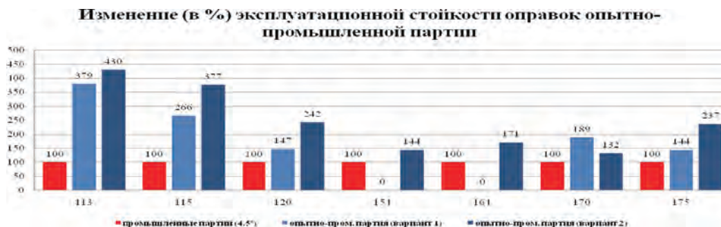
Рис. 5. Результаты промышленных испытаний опытно-промышленной партии прошивных оправок (значение 0 означает, что данные оправки не применялись)
