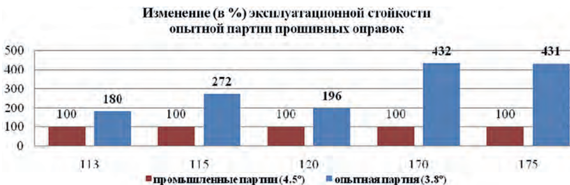
Рис. 3. Результаты промышленных испытаний опытной партии прошивных оправок
