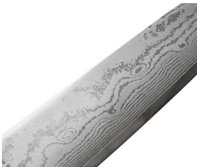
Рисунок 2. Пример структуры дамасской стали
