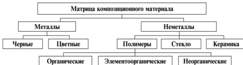
Рисунок 1 - Классификация композиционных материалов по виду матрицы
