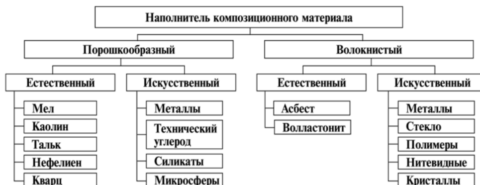
Рисунок 2 - Классификация композиционных материалов по виду армирующего компонента
