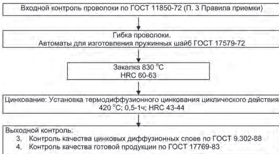
Рис. 3. Блок-схема процесса термической обработки, совмещенного с диффузионным цинкованием граверных шайб
