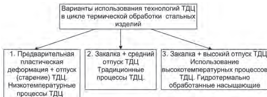
Рис. 2. Реализация процессов диффузионного цинкования в общем цикле термической обработки ряда металлоизделий
