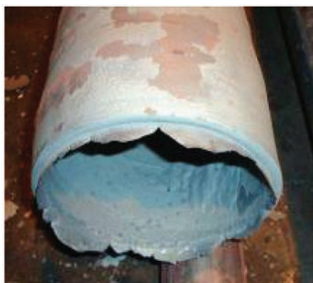
Рис. 6. Дефект на заднем конце гильзы
