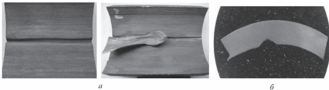
Рис. 10. Продирь четвертого вида на внутренней поверхности проб труб: а – внешний вид; б – поперечное сечение
