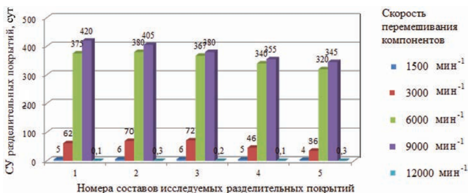
Рис. 3. Влияние скорости перемешивания компонентов на СУ эмульсии (время перемешивания 10 мин, температура подогрева исходных компонентов 70 \text{ }^\circ\text{C} )
