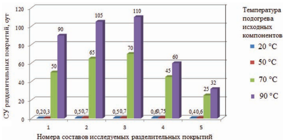
Рис. 1. Влияние температуры подогрева исходных компонентов на СУ эмульсий при скорости перемешивания 3000 мин -1 (время перемешивания 5 мин)
