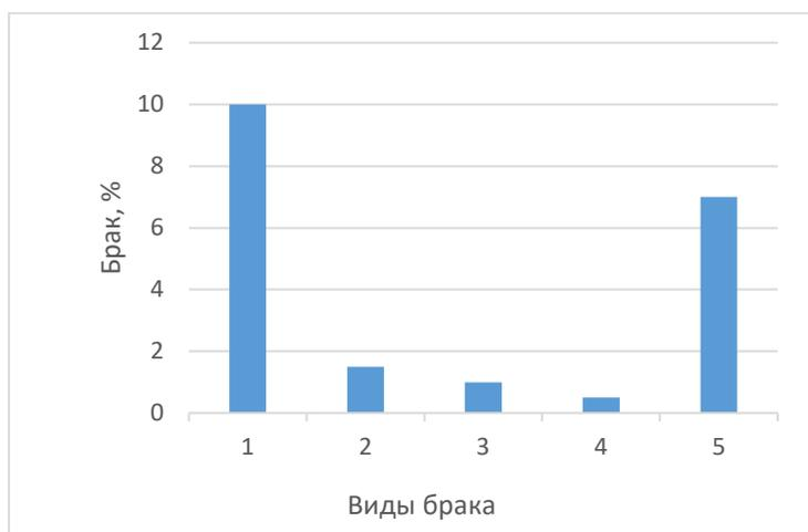
1 – общий; 2 – усадка; 3 – трещины; 4 – недолив; 5 – газовая пористость
