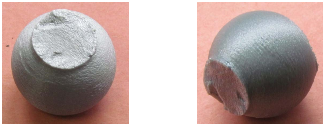
Рисунок 2 – Полученная твердотельная модель шаровой части разрушенного шарового шарнира рулевой тяги автомобиля
