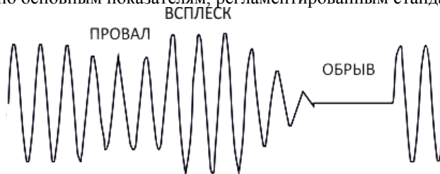
Рисунок 1 - Виды колебаний амплитуды напряжения в электрических сетях
