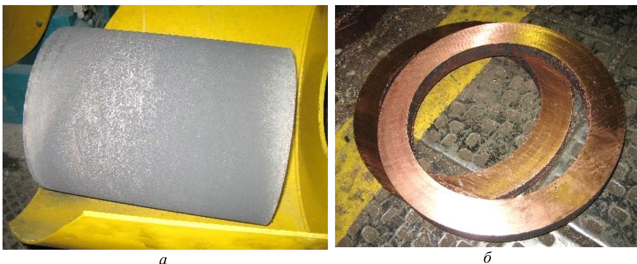
Рисунок 1 - Отливка из меди марки М1, полученная центробежным методом литья (а) и заготовки, вырезанные из нее (б)
