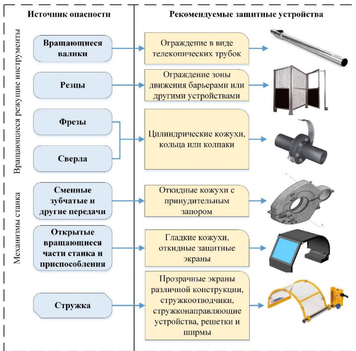
Рисунок 2 – Источники опасности и защитные устройства металлорежущих станков
