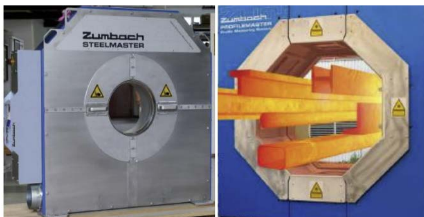
Рисунок 2– Измерительный прибор для автоматизации контроля качества готовой продукции
