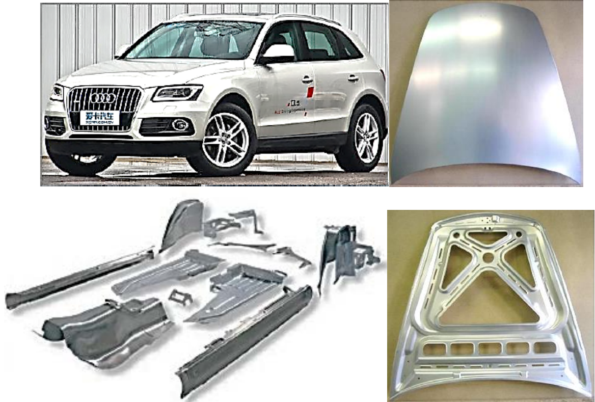
Рисунок 2 – Автомобиль и полученные штамповкой детали из алюминиевых сплавов, используемые в его производстве
