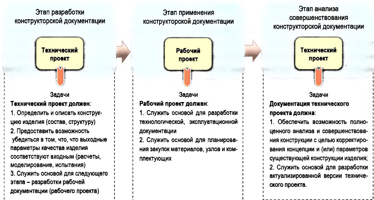
Рисунок – Этапы жизненного цикла конструкторского проекта
