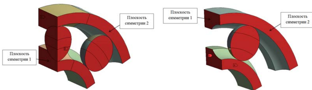
Рис. 2. Компьютерная трехмерная геометрическая модель четвертой части фрагмента объекта исследования для основных расчетных случаев нагружения
