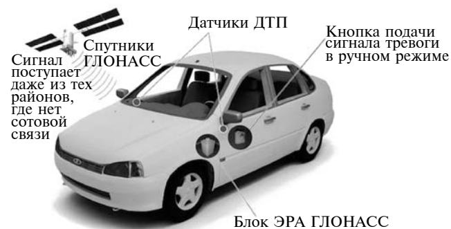
Рис. 4. Схема ЭРА-ГЛОНАСС системы экстренного реагирования при ДТП
