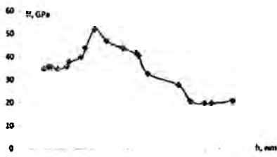
Рисунок 1 – Зависимость твердости от глубины внедрения индентора
