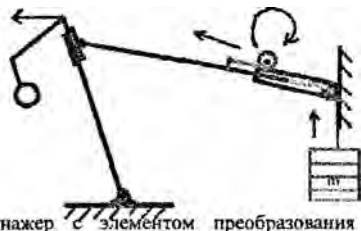
Тренажер с элементом преобразования мгновенного значения частоты (угловой скорости) вращения тросового барабана в пропорциональный электрический сигнал
