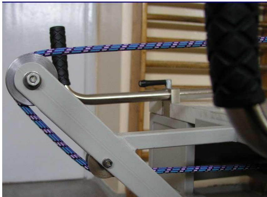
Рис. 6. Прохождение каната через ролики
