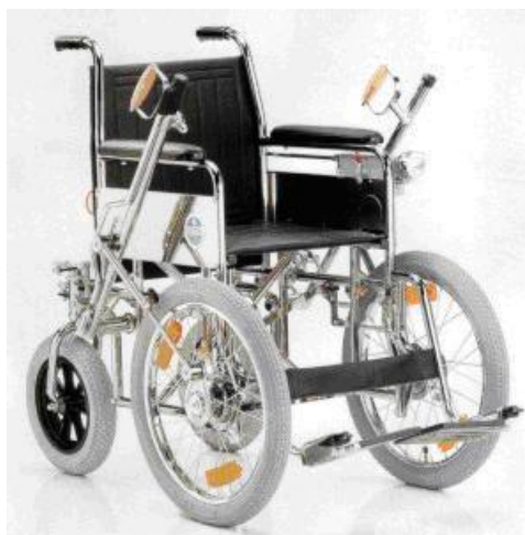
Рис. 1.118. Инвалидная коляска с приводом за рычаги
