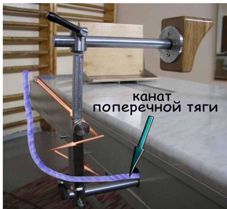
Рис. 9. Крепление каната на подвижном упоре
