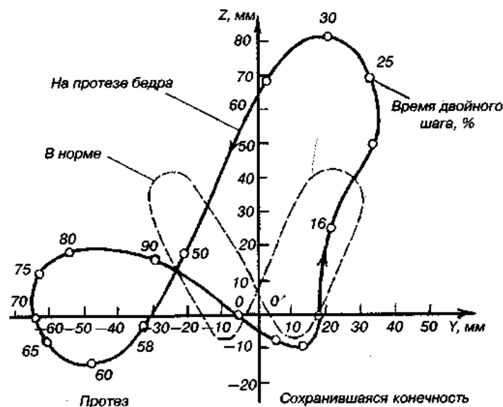
Рис. 2.11. Траектория ОЦМ тела человека при ходьбе в норме и на протезе бедра
