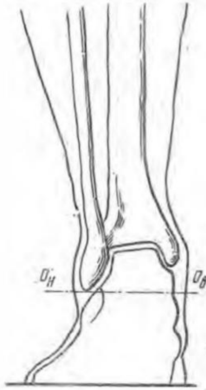
Рис. 2.14. Расположение условной оси голеностопного шарнира ортопедического аппарата.
