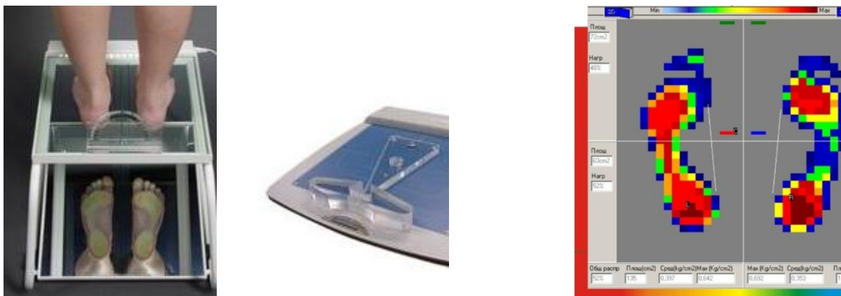
Рис. 1.12. Подометры и картина распределения давления под стопой
