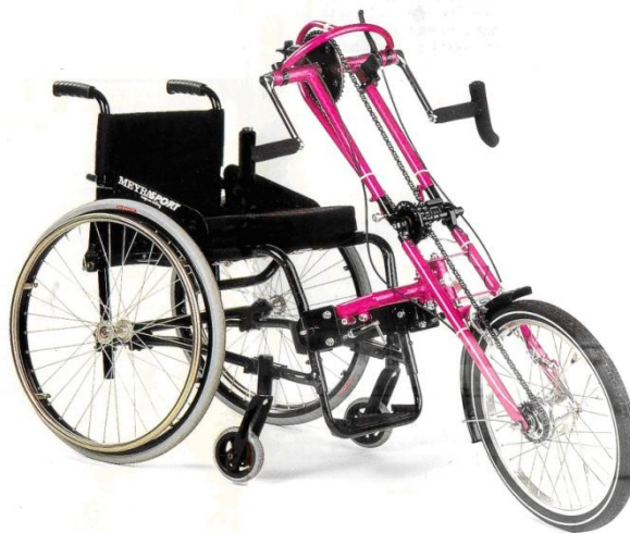
Рис. 1.119. Инвалидная коляска с велосипедным приводом и переключателем скоростей
