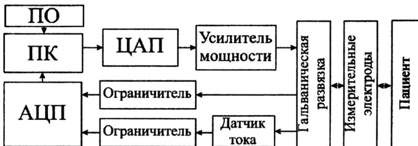
*Рис. 1. Структурная схема аппаратной части комплекса*
