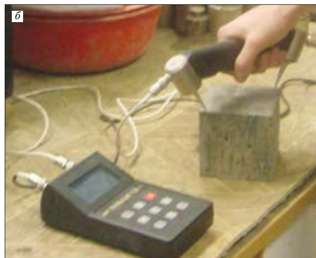
Рис. 1. Испытание методом упругого отскока прибором «ИПМ-1Б» (а) и ультразвуковым импульсным методом прибором «Пультар 1.0» (б)
