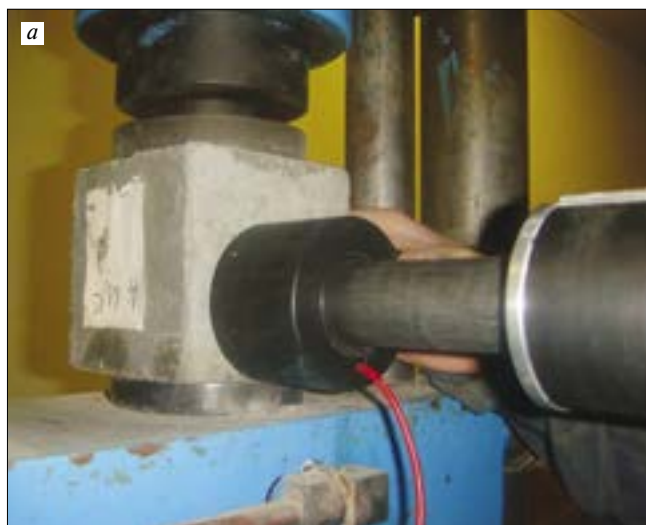
Рис. 1. Испытание методом упругого отскока прибором «ИПМ-1Б» (а) и ультразвуковым импульсным методом прибором «Пультар 1.0» (б)
