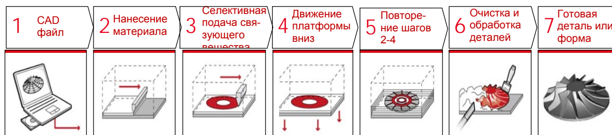
Рисунок 1 – Схема процесса 3D-печати литейных стержней
