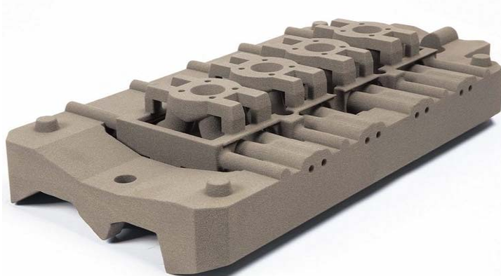
Рисунок 1 – 3D-принтер для плакированных смесей (а) и напечатанная форма (б)
