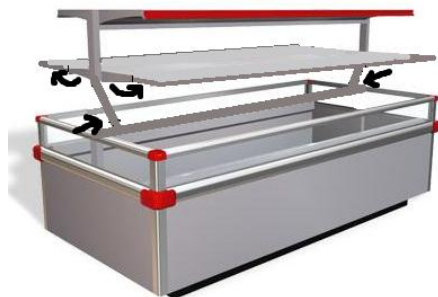
Рисунок 1 – Схема опускания надстройки
