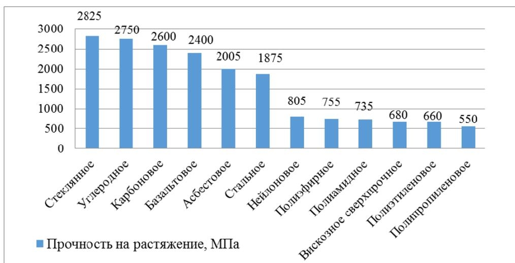
Рисунок 2 – Прочность на растяжение фибры из различных материалов
