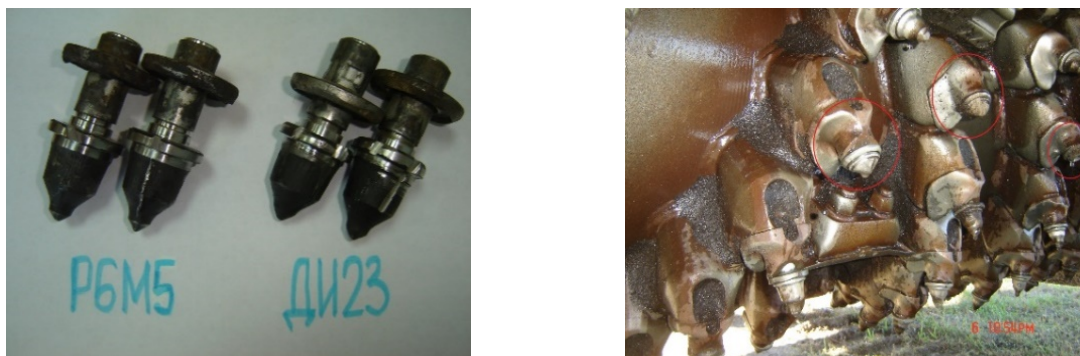
Рисунок 2 – Фото образцов биметаллических резцов для дорожных машин до испытания и после испытания на автодорогах РБ
