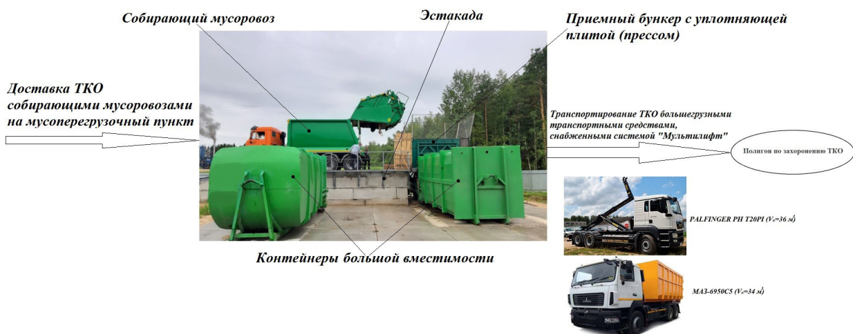
Рис.8. Двухэтапная система сбора и транспортирования ТКО с перегрузочным пунктом
