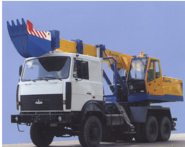
Рис. 2. Экскаватор-планировщик с телескопической стрелой EW-25-M1
