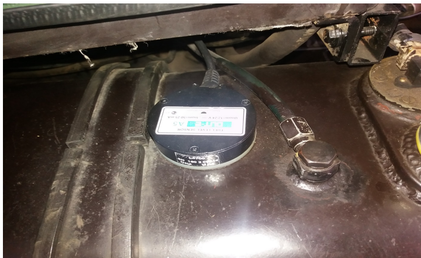
Рис. 4.19. Месторасположение датчика уровня топлива DUT-E на тракторе
