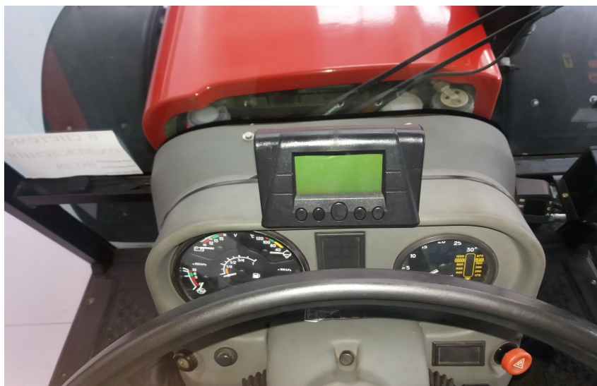
Рис. 4.21. Месторасположение терминала послерейсового контроля СКРТ 31 на тракторе
