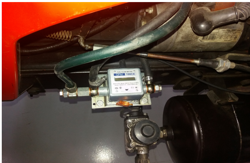
Рис. 4.20. Месторасположение расходомера топлива DFM-100CK на тракторе
