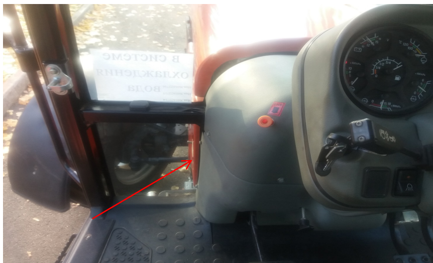
Рис. 4.22. Месторасположение антенны терминала СКРТ 45 обеспечивающего передачу параметров в режиме реального времени
