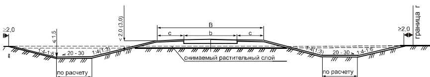
Рис. 8.3. Поперечные профили низких насыпей с кювет-резервом на неплодородных землях
