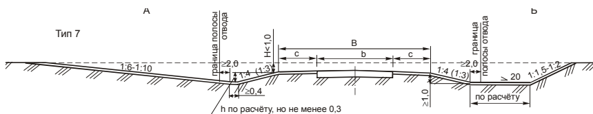
Рис. 8.4. Поперечные профили выемки глубиной до 1,0 м на снегонаносимых участках местности: а – раскрытая; б – разделанная под насыпь
