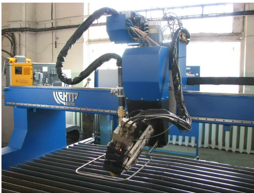
Рис. 1. Технологический комплекс плазменного раскроя материала с манипулятором для резки и разделки кромок заготовок под углом
