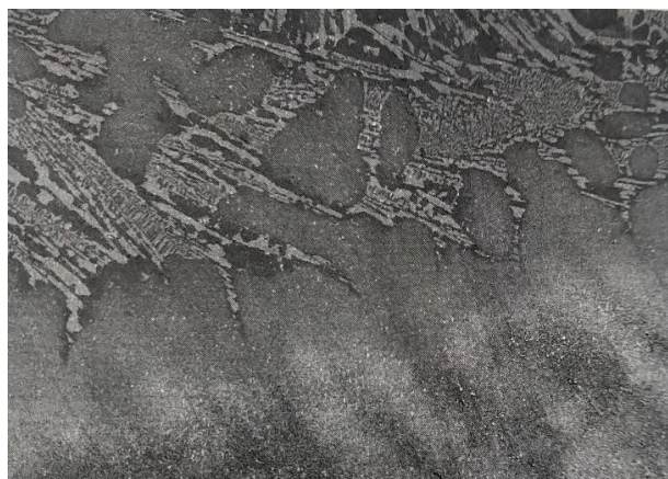
Рис. 4. Микроструктура межфазной границы сплав ЖС 6У-припой при увеличенном количестве легкоплавкой составляющей
