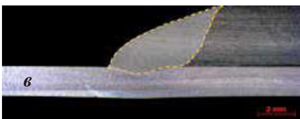
Рис. 2. Оборудование для плазменной сварки: а) сварочная головка Kjellberg; б) послойная сварка изделия; в) сечение сварочного шва (информация с сайта www.kjellberg.de )
