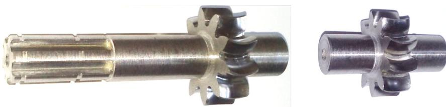
Рис. 3. Експериментальна пара зубчастих коліс з арочною формою зуба
