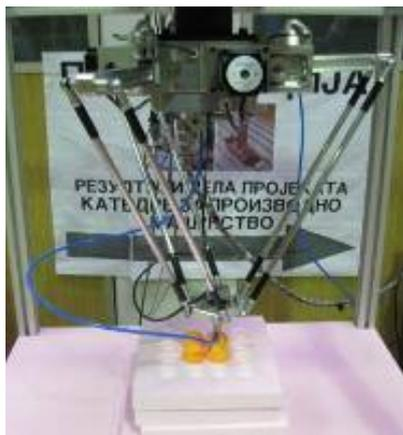
Рис. 9. ДЕЛЬТА-механизм с поворачивающимися шарнирами
