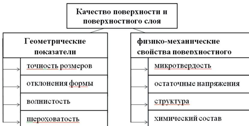
Рис. 1. Показатели качества поверхности и поверхностного слоя
