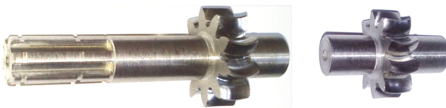
Рис. 3. Експериментальна пара зубчастих коліс з арочною формою зуба
