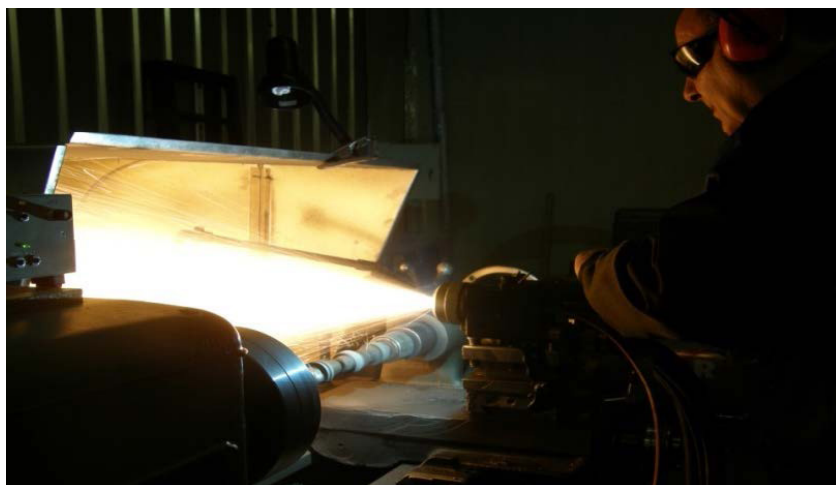
Рис. 1. Процесс восстановления распредела электродуговым напылением
