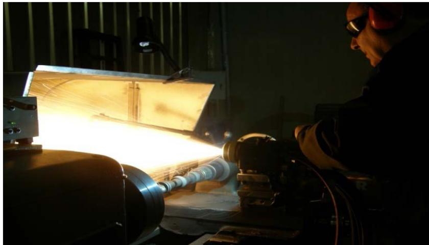
Рис. 1. Процесс восстановления распределителя электродуговым напылением
