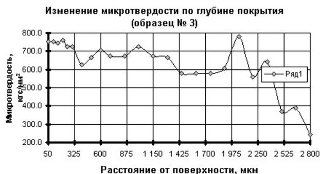
Рис. 2. Исследования микротвердости полученного покрытия
