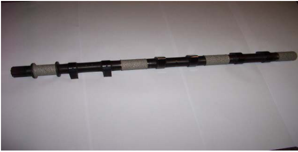
Рис. 4. Восстановленный (а) распредвал 14-04-20-1 двигателя Д-160.111-1 и после мехобработки (б)
