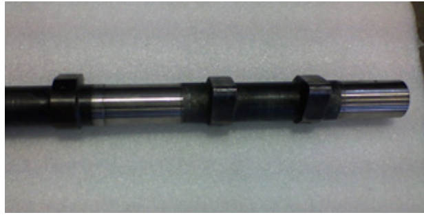
Рис. 4. Восстановленный (а) распредвал 14-04-20-1 двигателя Д-160.111-1 и после мехобработки (б)
