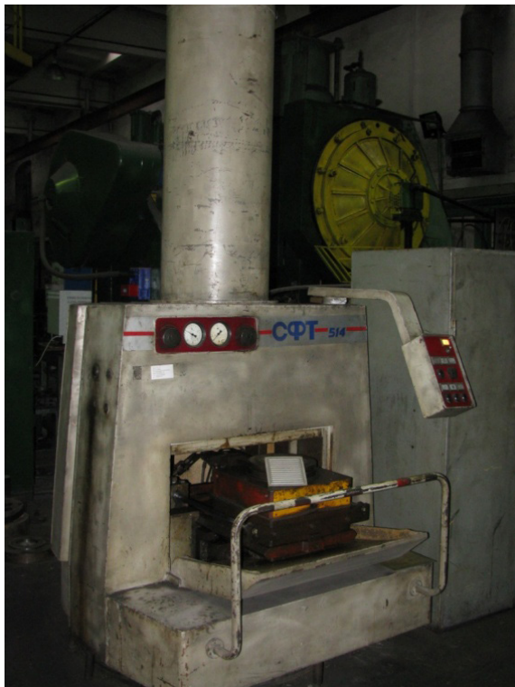
Рис. 4. Разработанные в ФТИ прессы для гидроударной штамповки через промежуточную среду: а – модель СФТ-514 для штамповки через полиуретан б – модель СФТ-510 для штамповки через станочную эмульсию
