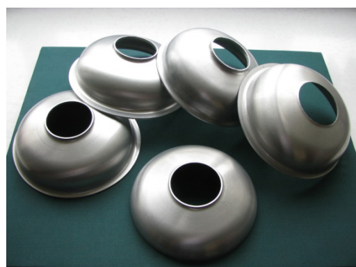
Рис. 6. Внешний вид деталей типа «полукамера» - являющихся составными частями резонатора ускорителя электронов, изготовленных из особо чистого ниобия в ФТИ импульсной гидроударной штамповкой
