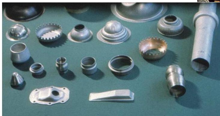
*Рис. 5. Примеры изделий, изготавливаемых в ФТИ НАН Беларуси импульсной гидроударной штамповкой*
