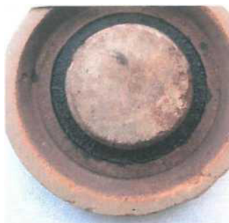
Рис. 4. Вид отливки и формы с нанесенным покрытием
