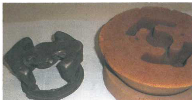
Рис. 4. Вид отливки и формы с нанесенным покрытием
