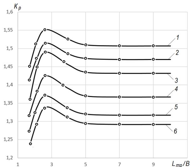
Рис. 3. Зависимость предельной степени раздачи от относительной длины трубчатой заготовки для материалов: 1 — медь М1М; 2 — нержавеющая сталь 12X18H10T; 3 — латунь Л63; 4 — алюминий А0; 5 — алюминиевый сплав АМцМ; 6 — сталь 10
