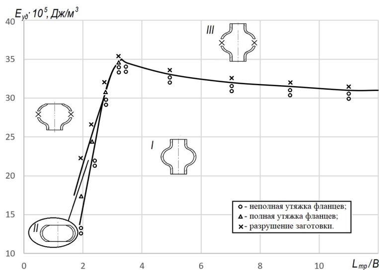
Рис. 2. График штампуемости для трубы из материала 12X18H10T
