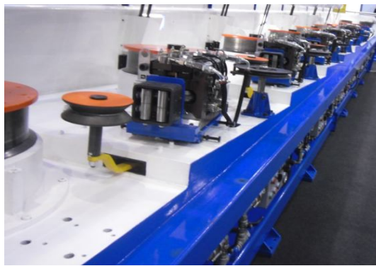
Рисунок 2 – Волочильное оборудование старого и нового образца: а – производительность 0,6–1,5 т/смену; б – 1,5–3,0 т/смену
