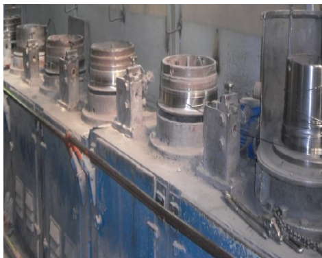
Рисунок 2 – Волочильное оборудование старого и нового образца: а – производительность 0,6–1,5 т/смену; б – 1,5–3,0 т/смену
