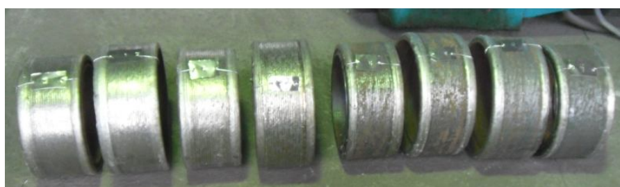
Рисунок 3 – Валки, наплавленные проволоками Велтек-Н215S, Велтек-Н225S
