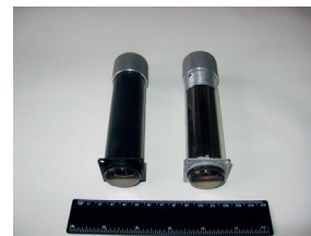
а б Элементы космической аппаратуры с экранами МПЭ: (а) корпуса линейного шагового двигателя (ЛШД) (обеспечение ЭМС) (б) фотоэлектронного умножителя ФЭУ-85 без экрана и с экраном из МПЭ (защита от магнитного поля)
