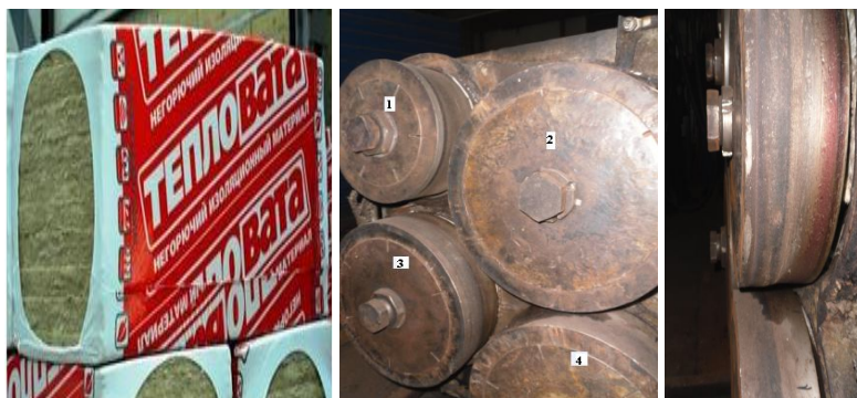
Рисунок 1 – Фото базальтовой ваты и валков центрифуги после износа
