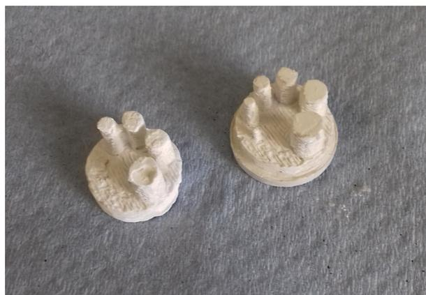
Рис. 3. Образцы керамики на основе ТКФ (слева) и ОКФ (справа)
