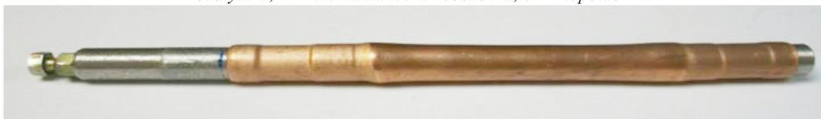
Рис. 6. Внешний вид образца перед волочением
