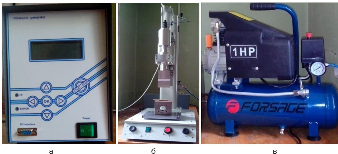
Рис. 1. Экспериментальная установка для ультразвуковой сварки полимеров: а — генератор ультразвуковых колебаний; б — пневматический пресс с пьезокерамическим преобразователем и пуансоном-волноводом; в — компрессор
